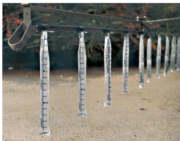
**Fig.25** - Il metodo più semplice per controllare l'usura degli ugelli è la verifica della loro portata, determinata per mezzo di contenitori graduati da applicare ad ogni singolo ugello.
