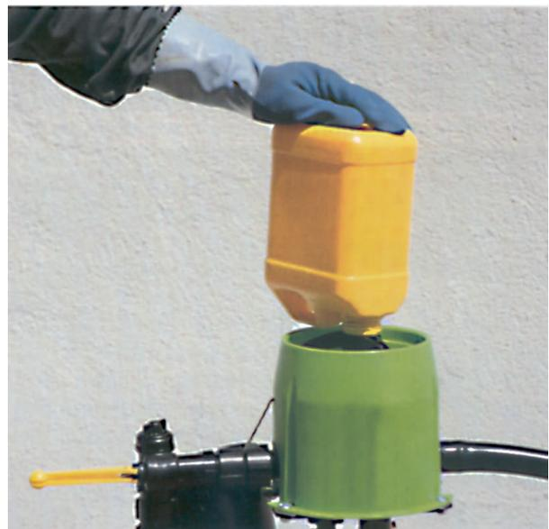
**Fig. 10** - Esempio di uso corretto di D.P.I. durante la fase di riempimento dei serbatoi delle macchine.
